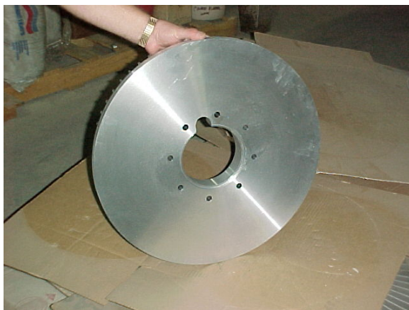
Rys.II.28. Kompozytowa tarcza hamulcowa jednostronna a/ powierzchnia robocza, płaska b/ powierzchnia tylna uźebrowana w celu zwiększenia intensywności odprowadzenia ciepła
