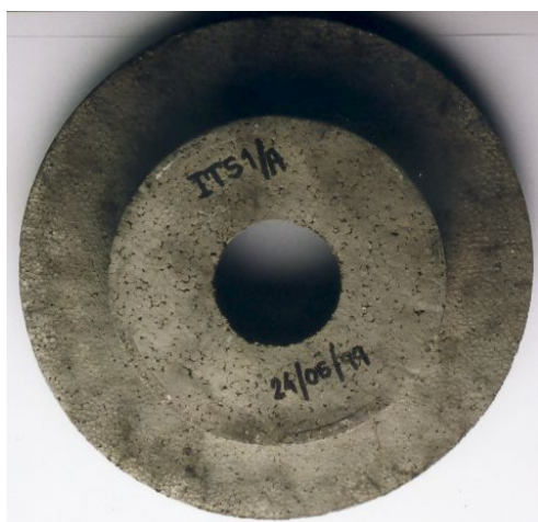
Rys.III.39. Pierwsze odlane w Polsce kompozytowe wentylowane tarcze hamulcowe.
