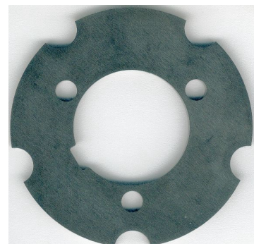
Rys.III.43. Tarcza hamulcowa żeliwna do gokarta po rozłożeniu a/ część robocza stanowiła wzorec do wykonania podobnej tarczy z kompozytu F3S.20S, b/ piasty tarczy hamulcowej
