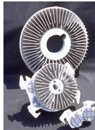
Rys.II.28. Kompozytowa tarcza hamulcowa jednostronna a/ powierzchnia robocza, płaska b/ powierzchnia tylna uźebrowana w celu zwiększenia intensywności odprowadzenia ciepła
