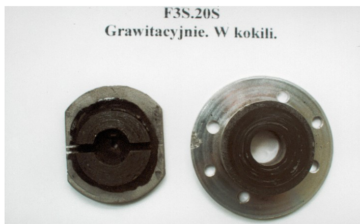
Rys.III.117. Przykładowa para cierna (okładzina i tarczka kompozytowa) po próbach na zużycie według cyklu standartowego (4 cykle zmiennych narastających temperatur - 0÷360°C).
