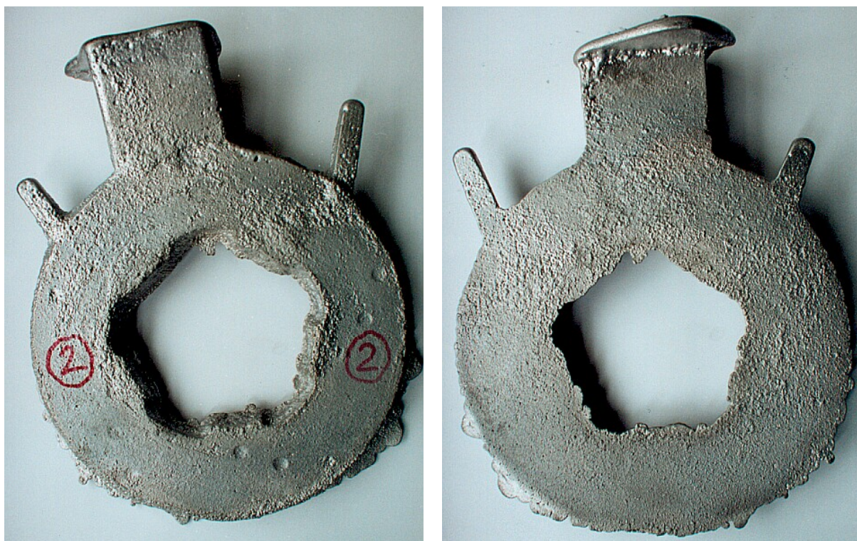
Rys.III.40. Pierwsza odlana w Polsce kompozytowa nie wentylowana tarcza hamulcowa.
