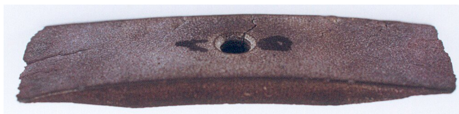
Rys.III.69. Wygląd zewnętrzny próbki żeliwa wermikularnego po badaniach odporność na szoki cieplne.
