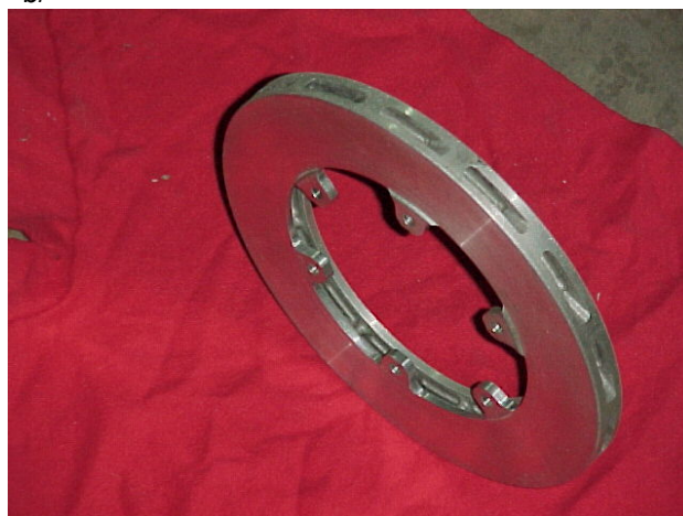
Rys.II.29. Kompozytowe tarcze hamulcowe nowej generacji przeznaczona do samochodów: a/ wyścigowych Formuły 1 (odlew piaskowy z kompozytu A356/20 obj. % SiC) b/ osobowych o zacięciu sportowym
