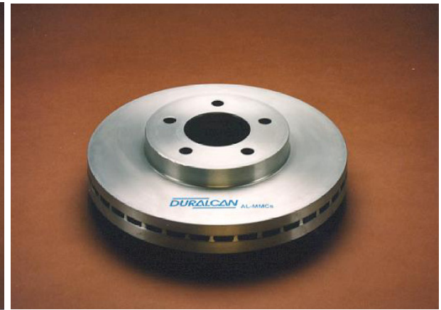
Rys. II.26. Kompozytowa przednia tarcza hamulcowa wentylowana do samochodu Ford Taurus (materiał F3S.20S)
