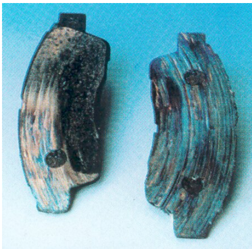
Rys. II.17. Zniszczone elementy pary cierniej na skutek za długiego okresu eksploatacji (źródło: BBA Friction/Textar)
