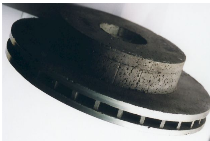
Rys.III.39. Pierwsze odlane w Polsce kompozytowe wentylowane tarcze hamulcowe.
