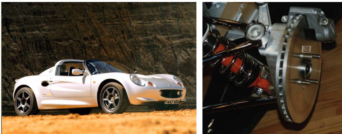
Rys. II.23. Tarcza hamulcowa z AIMC zastosowana w samochodzie sportowym LOTUS ELISE [24]
