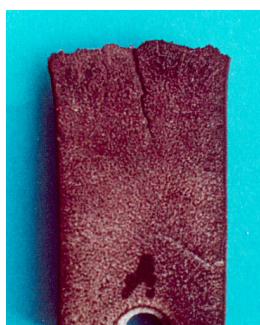
Rys.III.69. Wygląd zewnętrzny próbki żeliwa wermikularnego po badaniach odporność na szoki cieplne.
