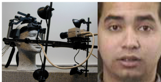
Rysunek 2.4: Stanowisko do akwizycji obrazów twarzy (źródło: [20])
