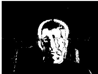
Rysunek 3.29: Obraz z wykrytym ruchem. Piksele uznane, za przemieszczone zostały oznaczone kolorem białym.
