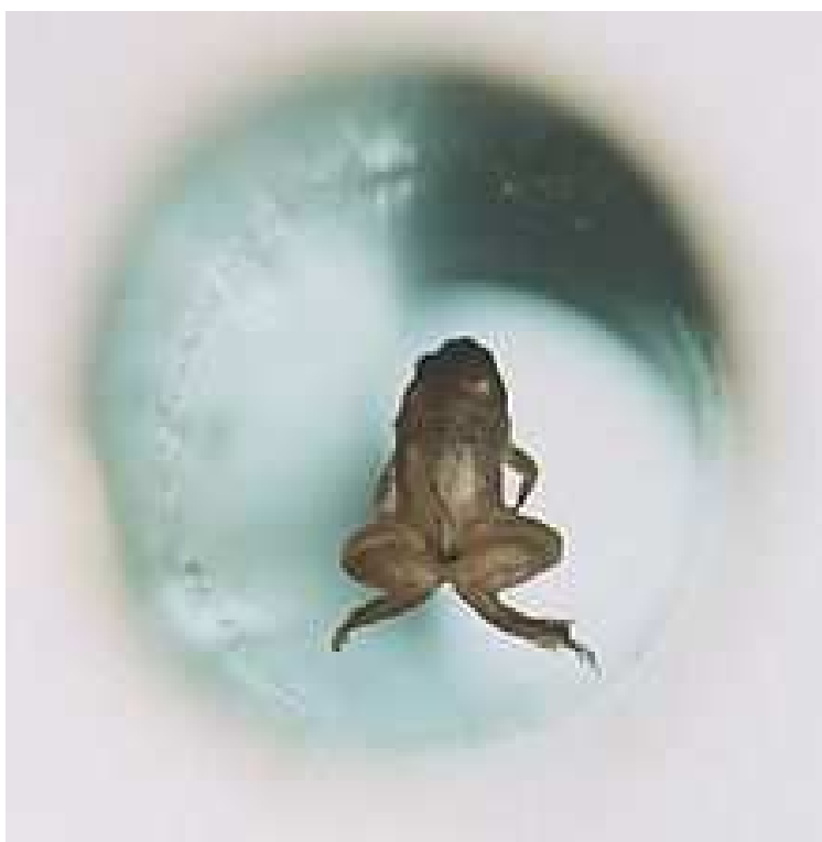
Rysunek 18.4.1: Lewitująca żaba w niejednorodnym polu magnetycznym
