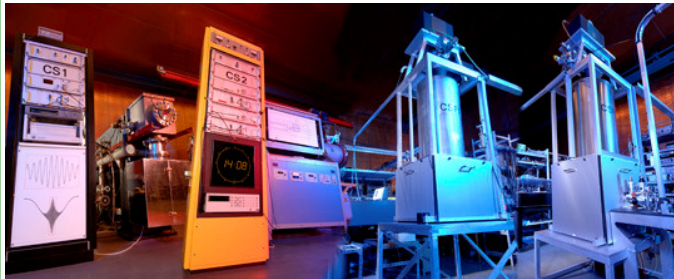
zegary cezowe w PTB Physikalisch-Technische Bundesanstalt Brunswick, Niemcy niepewność 1,2 \times 10^{-14} 1 \times 10^{-9} s/doba 1 s/ 2,7 \times 10^6 lat
